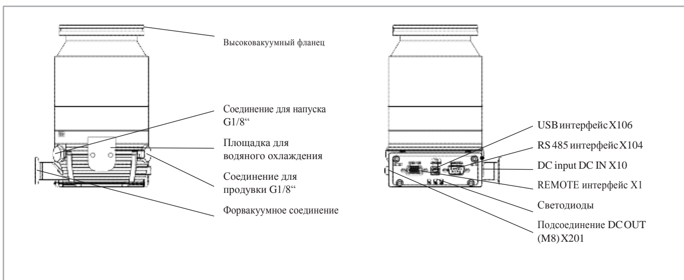
Рис. 3.10 Разъемы TURBOVAC 90i, TURBOVAC 250i похожи
